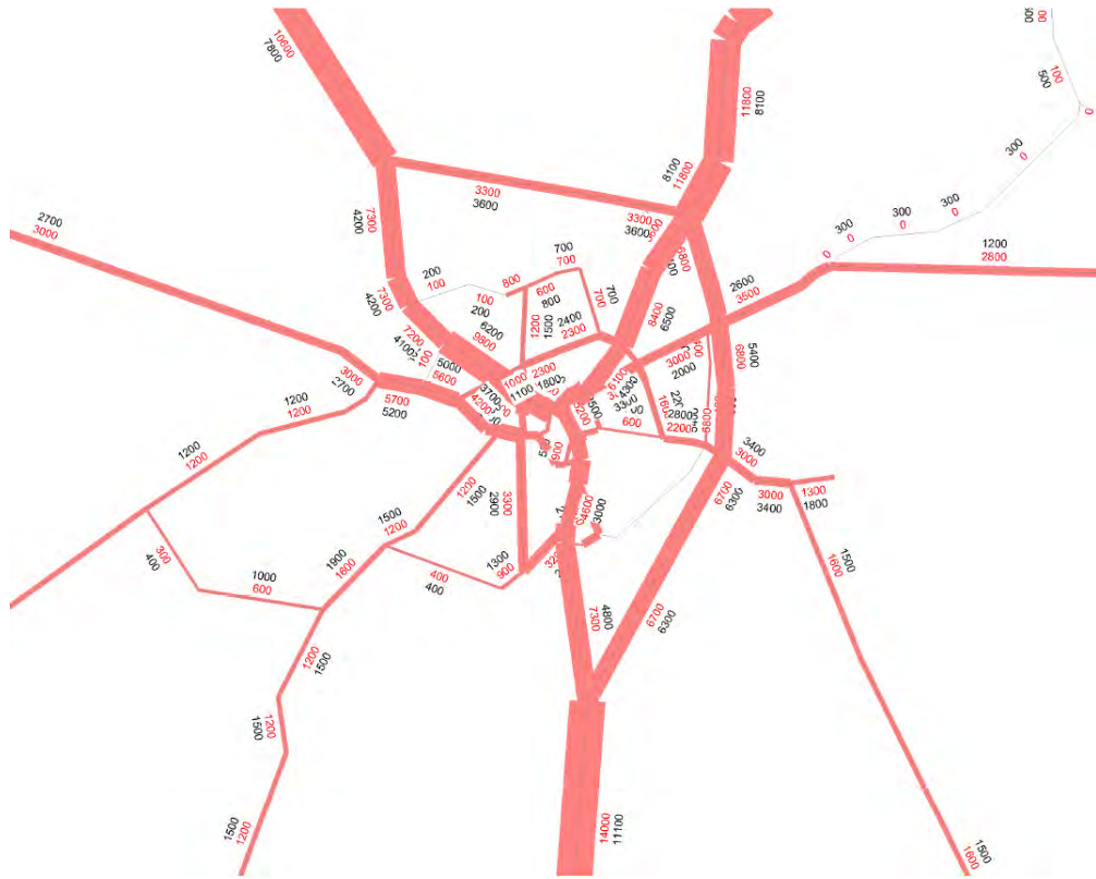
Figuur 6-4 – Verkeersintensiteiten (vtg/etmaal) in Baarle – geplande situatie 2015 – niet autoluw scenario (Grontmij, 2007) (getallen: zwart = werkdag; rood = zondag)
