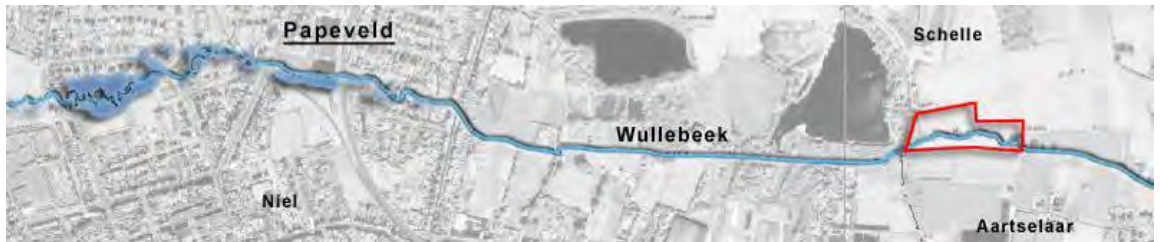
↑ figuur. de overstromingsgevoeligheid in de woonzone Papeveld dient in de toekomst vermeden te worden door de realisatie van het gecontroleerde overstromingsgebied aan de Wullebeek
