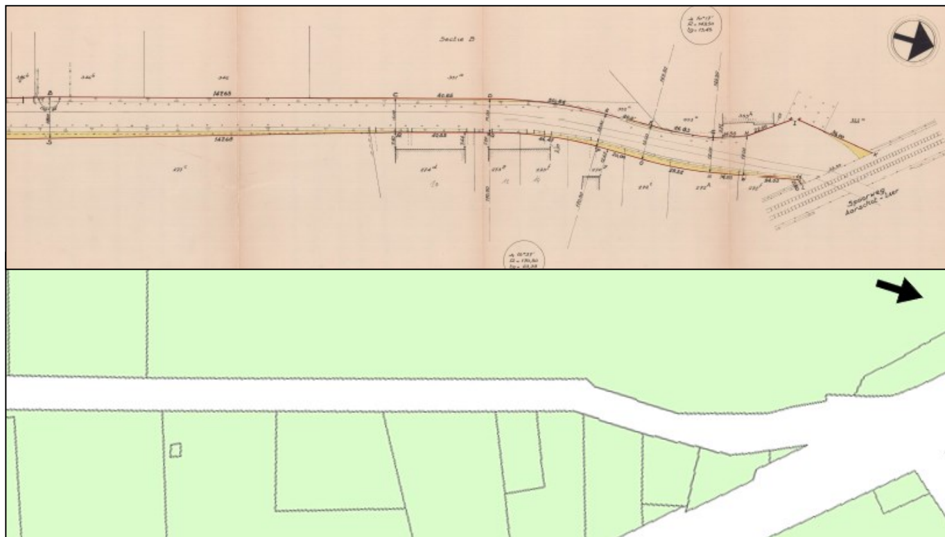
Figuur 31: Rooilijnplan Marnixdreef versus digitaal kadastraal perceelsplan
