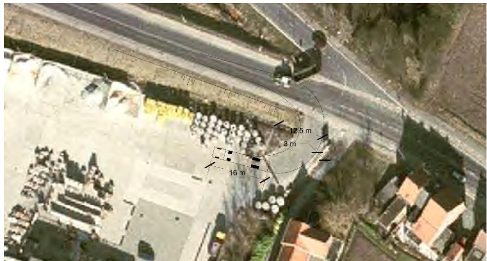
Figuur 6-5: Draaicirkel vrachtwagen (bron: Orthofoto's provincie Antwerpen, OC-GIS-Vlaanderen 2003; baanbeschrijving trekker met oplegger, CROW ASVV 1996)
