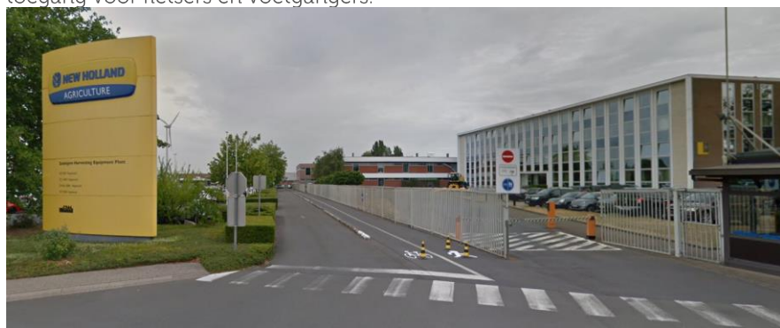
Figuur 42: toegang Case New Holland met scheiding van fietsers en voetgangers van het gemotoriseerd verkeer
