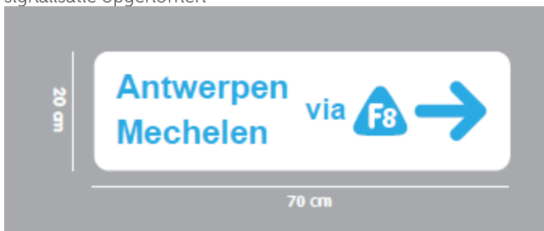
Figuur 45 Voorbeeld van borden richting fietsostrade
