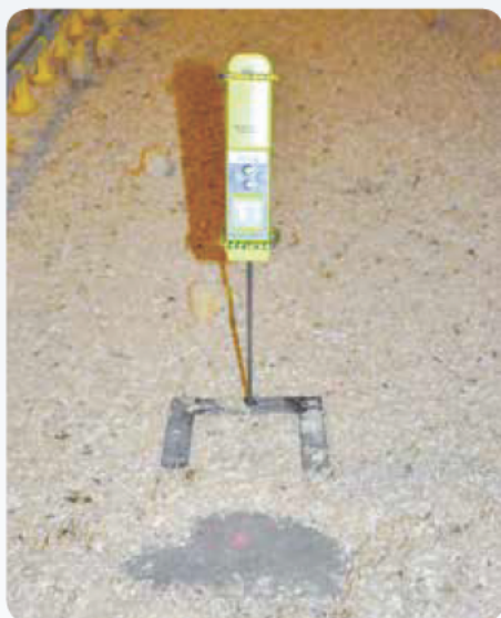
Foto 1: Infraroodthermometer voor meting van de temperatuur op de betonvloer en bovenop de strooisellaag
