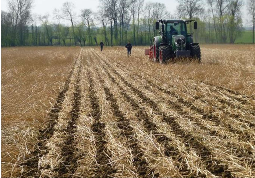
Enkel de zone waar de suikerbieten gezaaid worden, wordt bewerkt door de strip-till machine.
