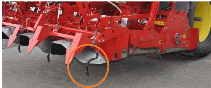
Woeltanden voor de schoepen van de drempelmaker (loonbedrijf Jona-Agri uit Wijtschate)
