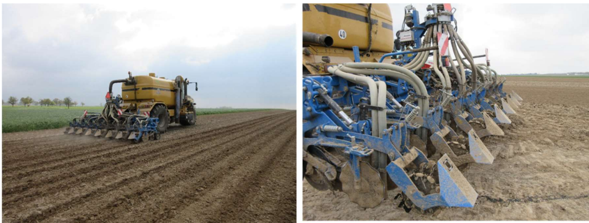
Strip-till met toediening van mengmest
