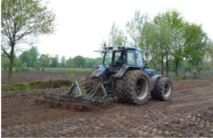
Figuur 20: Zaaibedbereiding met triltand en dubbellucht
