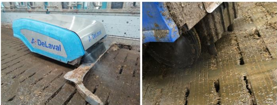
Figuur 10: (A) Delaval mestrobot in actie in de ILVO melkveestal. (B) Water vernevelen gebeurt achteraan de robot via 2 sproeikoppen aan beide zijden van de robot.
