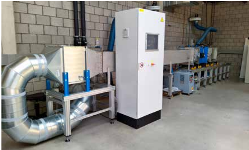
Figuur 30: Schematisch overzicht DAC en afbeelding van de DAC-pilootinstallatie in het VITO-laboratorium.
